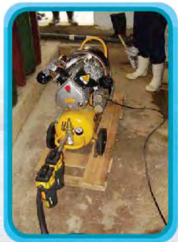
Figura 14 A. Compresor de aire de 3 HP empleado para la aireación del Estanque P2
